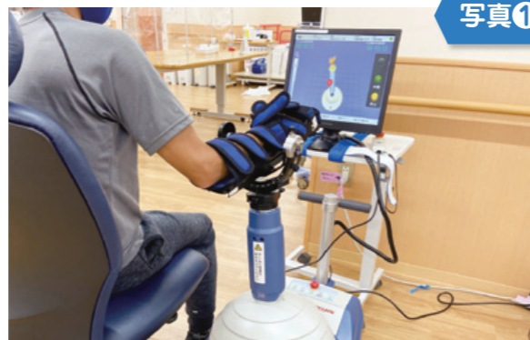
ReoGo-J コンピューター技術とロボット工学を応用した上肢用ロボット型運動訓練装置
